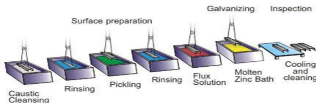
*Hot-dip galvanizing (HDG) adalah proses salutan keluli fabrikasi dengan menggunakan pelindung salutan zink untuk keluli atau besi, bagi mencegah daripada karat dengan merendamnya di dalam zink cair. Terdapat tiga langkah asas dalam proses Hot-dip galvanizing; penyediaan permukaan, galvanizing dan pemeriksaan.*
