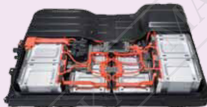
Gambar foto 3.5 Pek bateri dalam kenderaan elektrik
