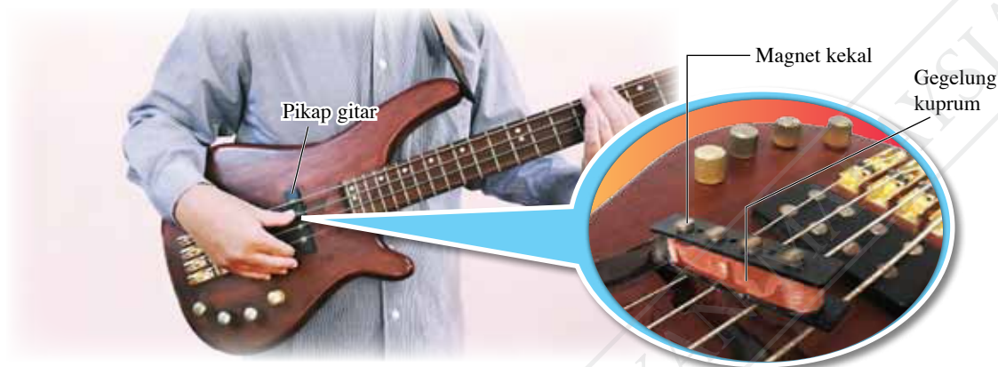
Gambar foto 4.4 Komponen dalam pikap gitar bass elektrik
