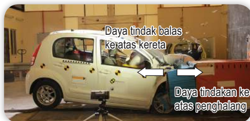
Gambar foto 2.9 Ujian perlanggaran kereta
