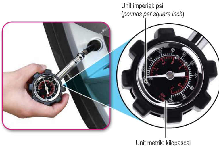
Gambar foto 1.2 Unit metrik dan unit imperial pada tolok tekanan tayar
